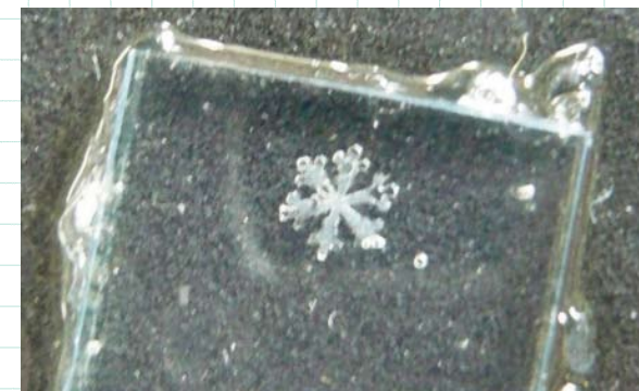
南極の雪の結晶のレプリカ(光硬化性樹脂製、×5倍撮影)。
