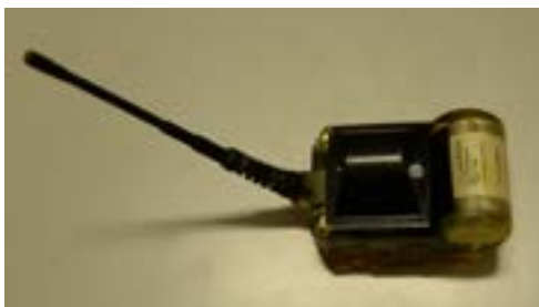
調査に用いたデータロガー。重さは580g。観測後はアザラシの体毛の抜け替わりとともに自然に取れます。このデータロガーは実際にアザラシに装着し、観測後に回収されたもの。
