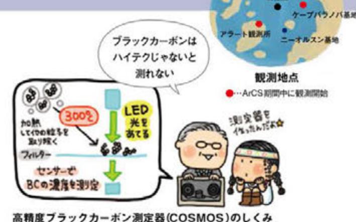
高精度ブラックカーボン測定器(COSMOS)のしくみ
