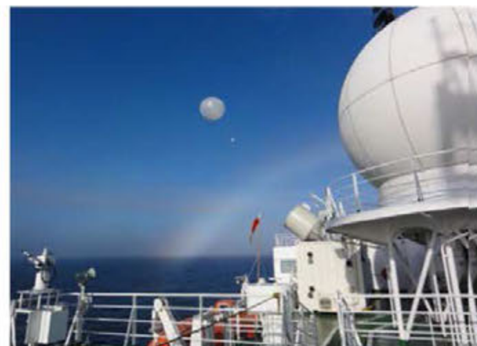
ミッション1の海上気象観測の様子。観測用気球を上空に放して気温、湿度、風向、風速等を観測し、船にデータを送信する。
